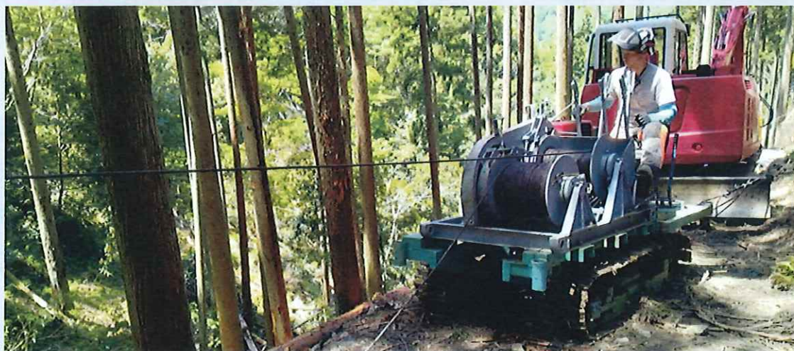
(和知地区大簾団地での集材機による間伐材の搬出)
