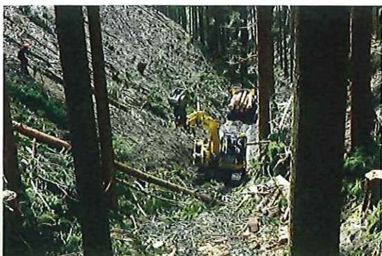
高性能林業機械(スイングヤーダ)での作業
