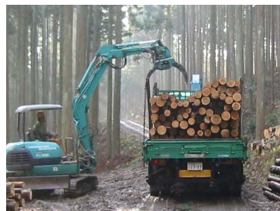
⑥積込作業:木材グラップル
